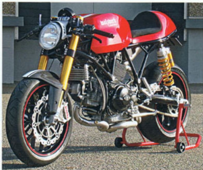
Komplettes Öhlins-Ornat für die Dämpfung und den Scheinwerfer einer Harley V-Rod als Glücksgriff für die knuffige Frontpartie
